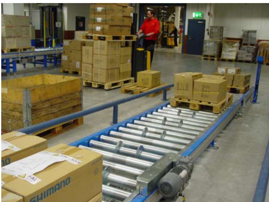
Godsheis mellom etasjene, med transportbånd.
